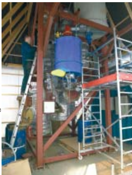
Forgasningsanlægget under klar- gøring på Danmarks Tekniske Uni- versitet.
