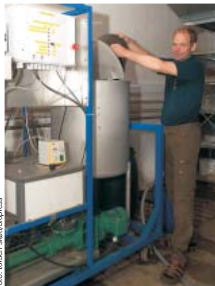
Henrik B. Møller hælder gylle i fontanen til en af de fire forsøgsreaktorer på gyllelaboratoriet.
