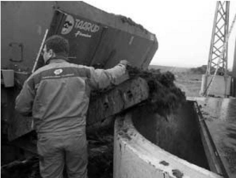
Bild 4. Avlastning av vallgröda från mixervagn till blandningsbehållare. Foto: Åke Nordberg
